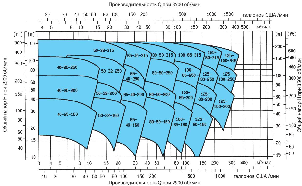
**Диапазон рабочих характеристик: 1450 об/мин при 50Гц, 1750 об/мин при 60Гц**
