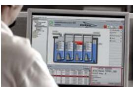
Система диспетчерского управления и сбора данных Flygt AquaView SCADA позволяет дистанционно управлять подключенным к сети станциями или оборудованием, обеспечивая полный обзор рабочего состояния.
