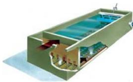
Решение ICEAS является комплексной системой биологической очистки, которая обеспечивает экономичную обработку сточных вод до требуемого качества очистки на выходе. Гибкая, простая и энергоэффективная система включает мелкопузырчатые
