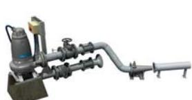
Эжекторная мешалка Flygt предназначена для создания объемного потока в резервуаре. Основными компонентами мешалки являются сопло, эжектор и насос. Насос создает первичный поток, который подается в резервуар через
