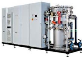
Wedecco SMO/SMA - компактная, полностью комплектная система для эффективной и надежной обработки озоном производительностью от 200 до 20 000 гO<sub>3</sub>/ч. Установленные во всех генераторах озона запатентованные электроды EFFIZON HP обеспечивают
